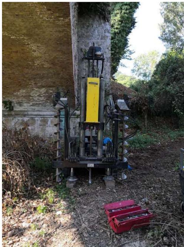
**Figura 22: Prova penetrometrica dinamica superpesante DPSH1.**
