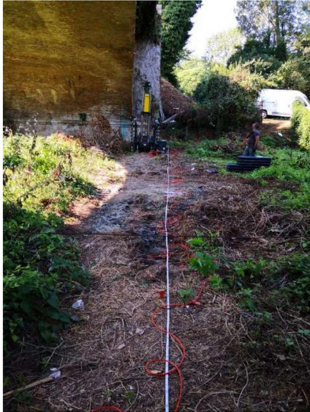
**Figura 24: Stendimento linea sismica per l'acquisizione della MASW1.**
