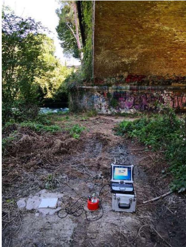
**Figura 30: Punto di acquisizione della misura di rumore sismico ambientale HVSR1.**
