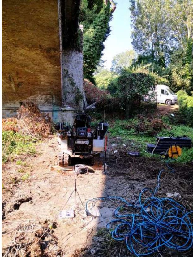
**Figura 38: Postazione della prova Down Hole.**
