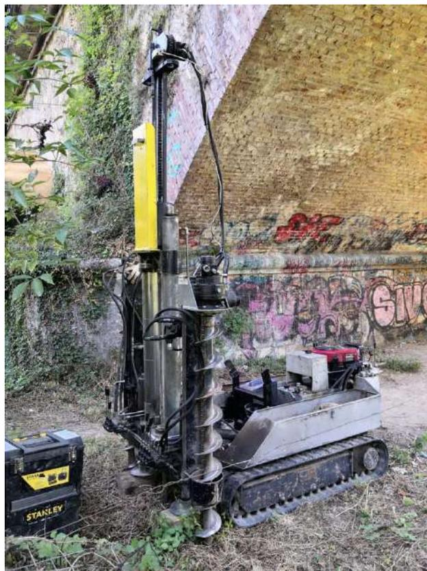
Figura 23: Prova penetrometrica dinamica superpesante DPSH2.
