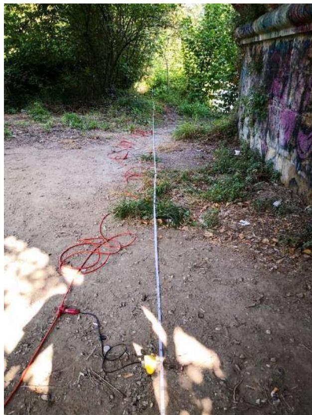
Figura 27: Stendimento linea sismica per l'acquisizione della MASW2.
