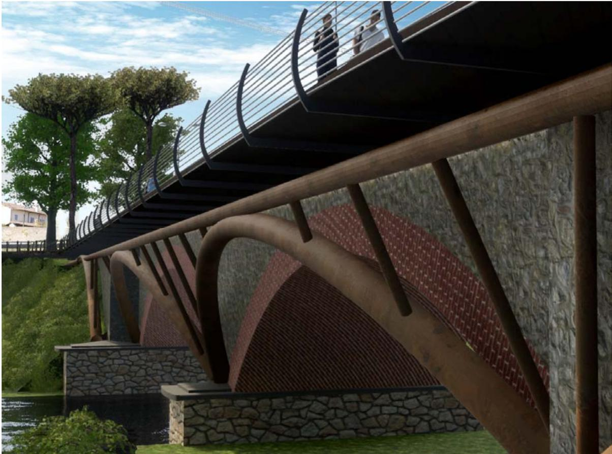
La lato dei rilevati di accesso al ponte le arcate della pista ciclopedonale saranno realizzate similmente alle altre e vincolate ai rilevati esistenti tramite un cordolo in C.A. .
